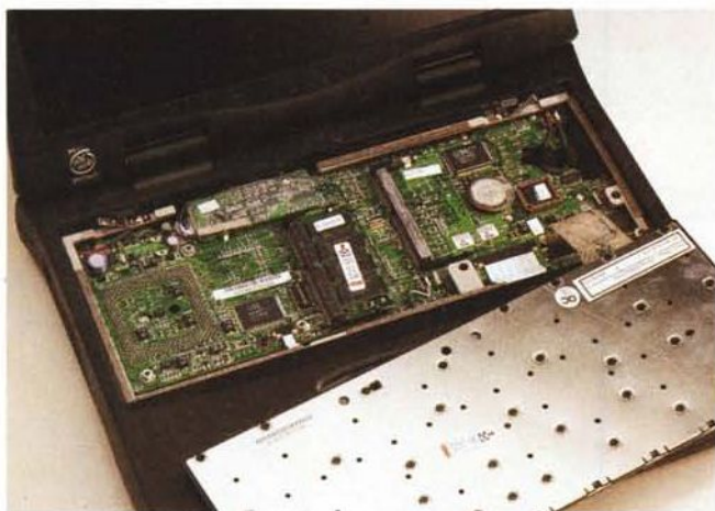
La RAM è situata sotto la tastiera, facilmente sollevabile. I due slot SODIMM possono ospitare fino a 128MB di RAM.
